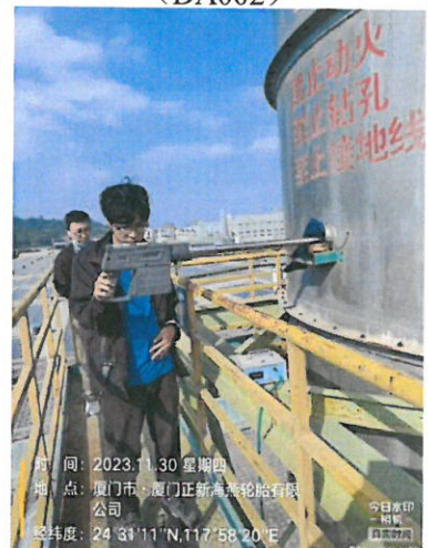
505 硫化车间排气筒出口 (DA016)
